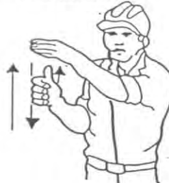
4 Levantar el aguilón o pluma lentamente
