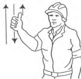
4 Levantar el aguilón o pluma lentamente
