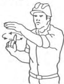
3 Levantar la carga lentamente
